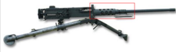
vue de droite, Mitrailleuse Browning M2HB-QCB refroidie par air de fabrication actuelle avec canon rapidement remplaçable, sur trépied M3
