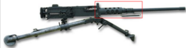
vue de droite, Mitrailleurse Browning M2HB-QCB refroidie par air de fabrication actuelle avec canon rapidement remplaçable, sur trépied M3
