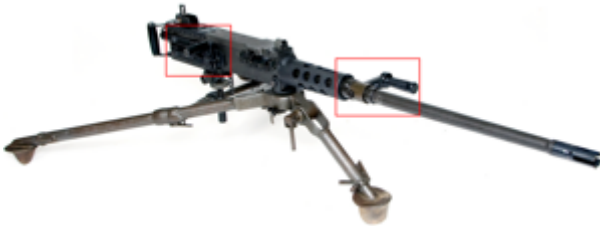
caractéristiques, la nouvelle modification M2E2 avec canon rapidement remplaçable
