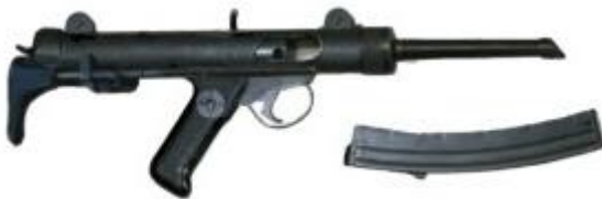
vue de droite, Copie chilienne de la mitraillette Sterling avec des différences à l'extérieur, telle que la crosse escamotable en métal et l'absence du manchon du canon
