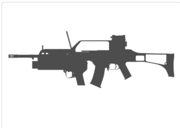
Le G36 a été développé dans les années 1960 et adopté par plusieurs forces armées telles que la Bundeswehr allemande et les forces armées espagnoles. Cette arme fonctionne par emprunt de gaz et possède une culasse rotative et un système de tenon de verrouillage multiple, contrairement aux systèmes traditionnels de culasse semi-verrouillée à rouleaux d'Heckler & Koch. La base de crosse se rabat sur la droite. En 2012, plusieurs rapports ont signalé la surchauffe des fusils G36 en Afghanistan,
