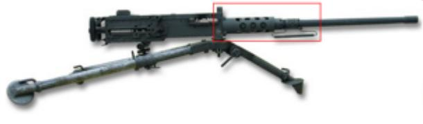
vue de droite, Mitrailleurse Browning M2HB-QCB refroidie par air de fabrication actuelle avec canon rapidement remplaçable, sur trépied M3
